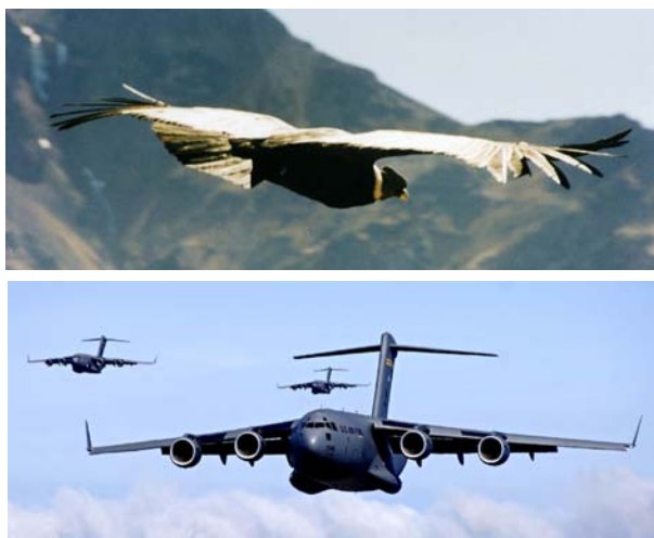
Abb. 6 Oben: Natürliche Winglets beim Kondor (gefächert) für den Langsamflug (Attribution: Ester Inbar, available from https://commons.wikimedia.org/wiki/User:ST ), unten: Winglets am C-17-Transportflugzeug (U.S. Air Force photo/Tech. Sgt. Shane A. Cuomo; Gemeinfrei).
