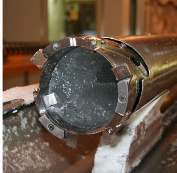
**Abb. 4** Bohrkopf mit Eiskern.
