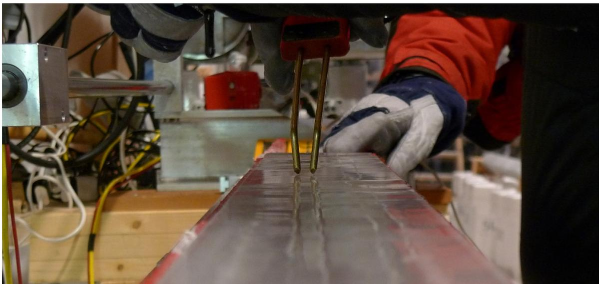
**Abb. 19** Messung der elektrischen Leitfähigkeit (ECM) direkt am Eiskern.
