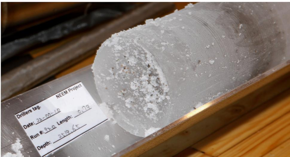
**Abb. 10** Eiskern der Bodenzone mit kleinen Gesteinsbruchstücken, Tiefe 2519,65 m.
