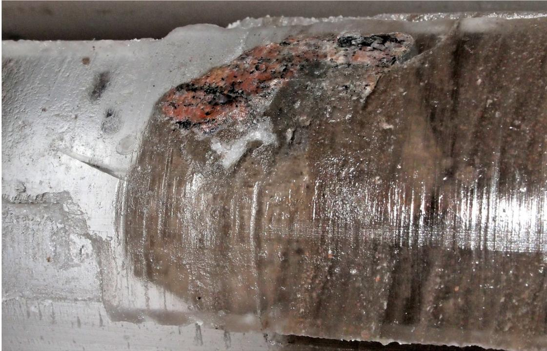
**Abb. 9** NEEM-Eiskern der Bodenzone mit Einschlüssen von Granit.
