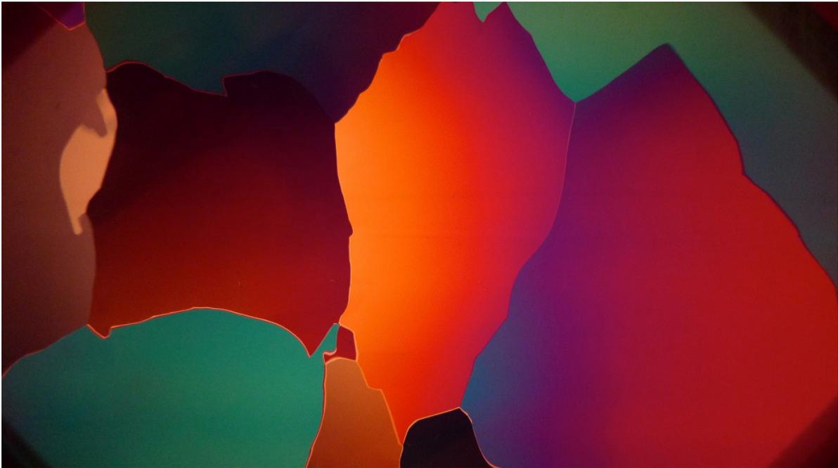
**Abb. 29** Eiskristalle im polarisierten Licht.
