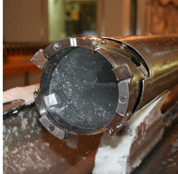
**Abb. 4** Bohrkopf mit Eiskern.
