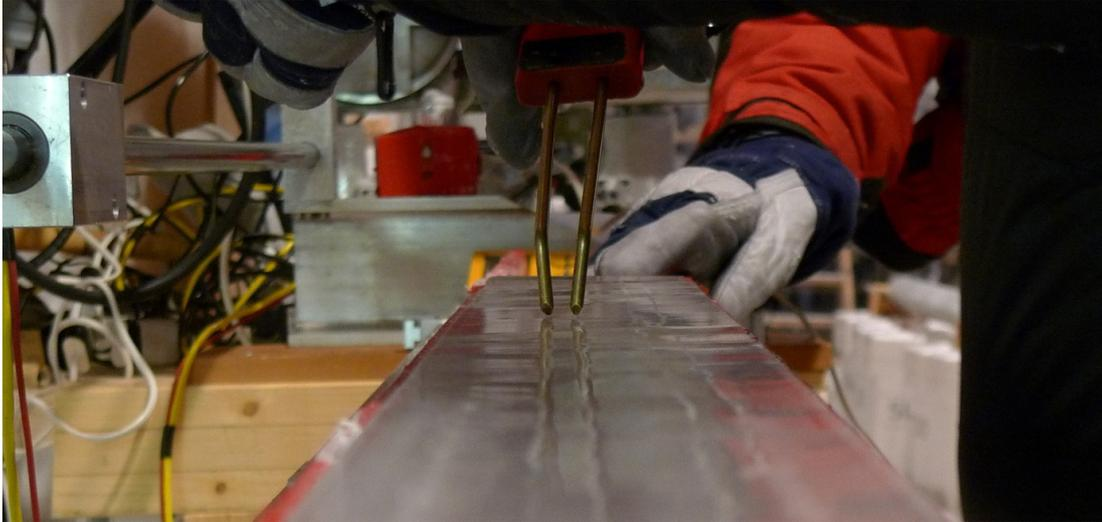
**Abb. 18** Messung der elektrischen Leitfähigkeit (ECM) direkt am Eiskern.
