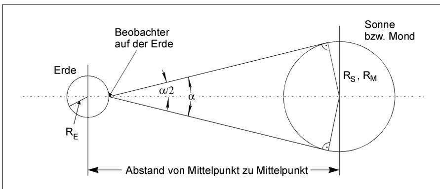
**Bild 2: Skizze zur Berechnung des scheinbaren Durchmessers**
