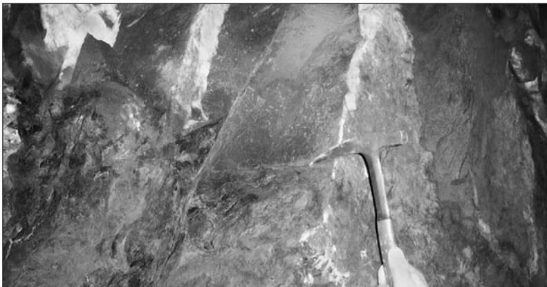
Abb. 5: Schichtfuge zwischen Unt. Erz-lager (unten) und Lagerquarzit (oben) an der Spitze des Hammerkopfes im unverwitterten Gestein; auch hier fehlt jeder Hinweis auf längere Sedimentationsunterbrechungen. Ehemalige Eisenerzgrube bei Wittmanns-gereuth, Untertage-Revier Breiter Berg.
